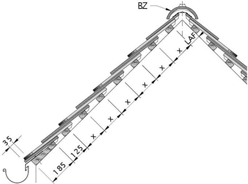
Zeichnung KLASSIK Dachquerschnitt bei Doppeldeckung DGD-2
