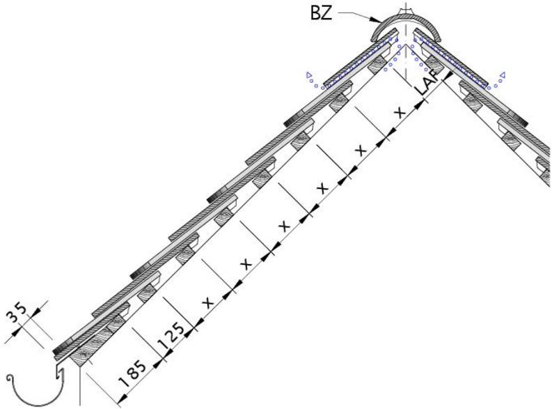
Zeichnung KLASSIK Dachquerschnitt bei Doppeldeckung DGD-1
