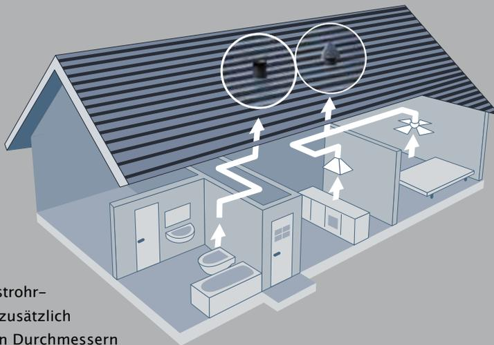
Die neuen Dunstrohr-Elemente sind zusätzlich erhältlich in den Durchmessern DN 150/160 und DN 200.
