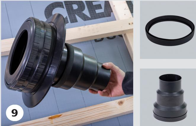
Bei kleineren Durchmessern der Haus-Anschlussleitungen kann die Reduziermuffe E für die Durchmesser 125/100/90 verwendet werden. Die Reduziermuffe E wird mit der Dichtung F auf den Grundträger D gesteckt und auf festen Sitz geprüft.
