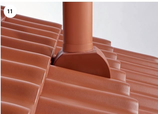
Das Thermrohr wird lotrecht ausgerichtet. Der Anschluss an die Dampfsperre bzw. Luftdichtungsschicht sowie an die Wärmedämmung erfolgt nach den Angaben des Regelwerks des Deutschen Dachdeckerhandwerks.
