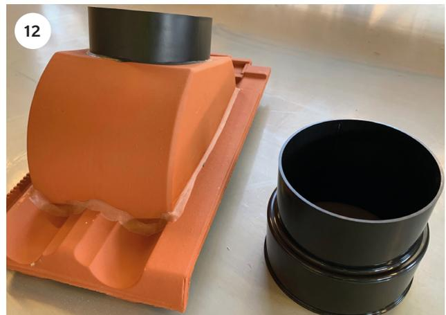
Der Thermendurchgangziegel wird in der Größe DN 125 mit dem im Karton befindlichen Adapter DN 110 ausgeliefert. Bei der Verwendung von DN 110 wird der Adapter auf den eingearbeiteten Kunststoffring DN 125 aufgesetzt. Wir empfehlen den Adapter mittels Schraube oder Kleber an dem Kunststoffring des Thermendurchgangs zu fixieren.
