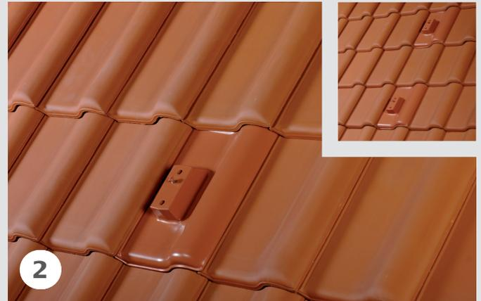
Für eine Dachleiter (1,68 m lang) werden zwei Aluminium-Grundelemente und zwei Halterungen benötigt. Der Abstand der Halterungen richtet sich nach dem jeweiligen Dachziegelmodell.
